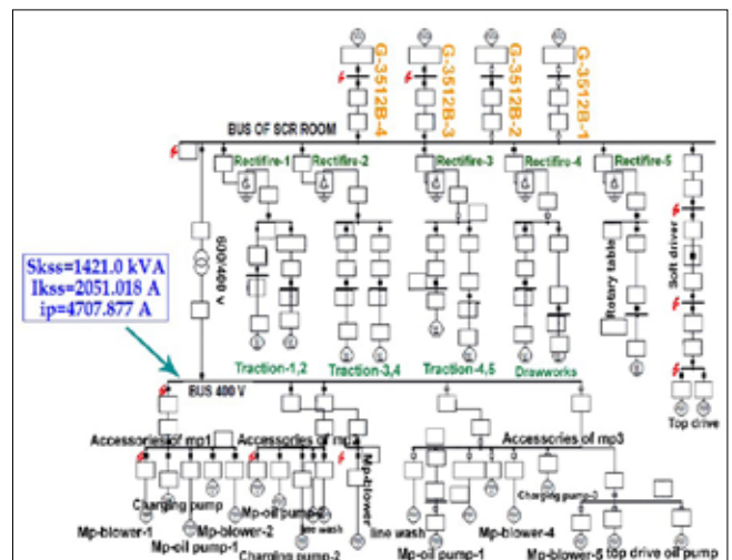
شکل ۳ | محل اتصال در باس ۴۰۰ ولت یا باس بعد از ترانسفورماتور
